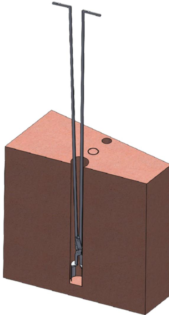
**Wir fertigen für Sie Ihre Kernfangzange mit abgewinkeltem Handgriff in der Größe und Länge die Sie für eine leichte Entnahme von Bohrkernen benötigen. Zum Beispiel auch als Tiefenlochkernfangzange (2 Meter) mit Hebevorrichtung.**
